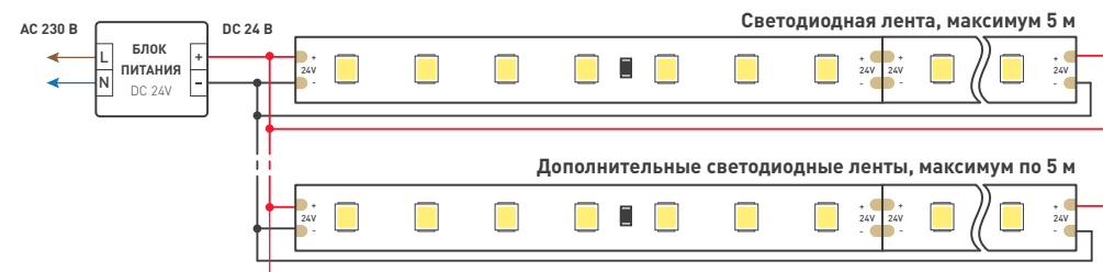
Схема 2. Подключение нескольких светодиодных лент с двух сторон
