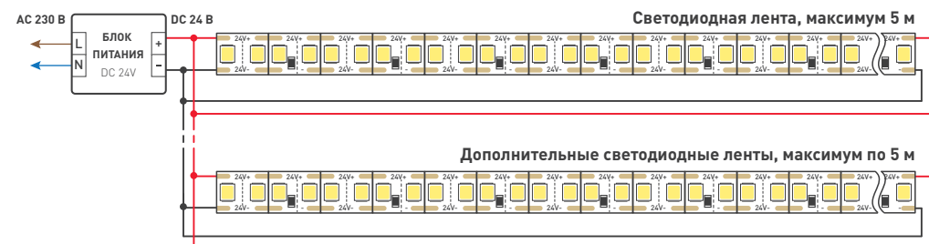
Схема 2. Подключение нескольких светодиодных лент с двух сторон
