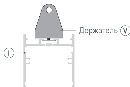
Рис. 1. Установка держателя в паз профиля. Вид сбоку
