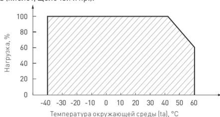
Рис. 2. Максимальная допустимая нагрузка, % от мощности источника
