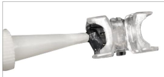
Зачистите изоляцию провода на длину не менее 10 мм, избегая повреждений токопроводящей жилы. Вставьте провода в разъемы до упора. Нанесите силиконовый герметик по контуру крышки. Закройте и зафиксируйте крышку до щелчка.
