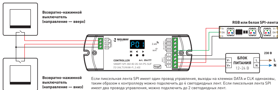
Рис. 3. Схема подключения контроллера при лестничном освещении
