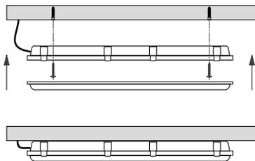
Рис. 3. Установка и подключение светильника накладным способом
