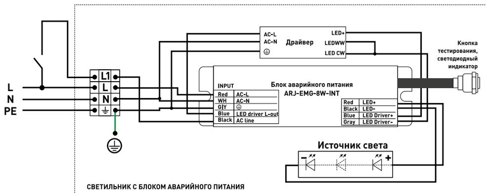
Рис. 4. Электрическая схема подключения моделей с БАП 047605
