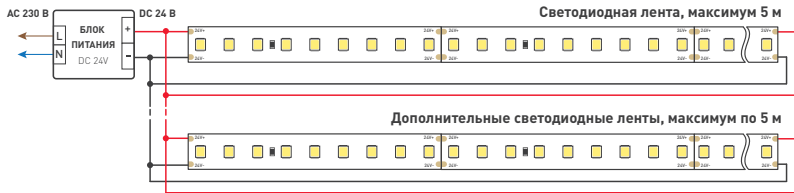
Схема 2. Подключение нескольких светодиодных лент с двух сторон для обеспечения равномерного свечения ленты по всей длине
