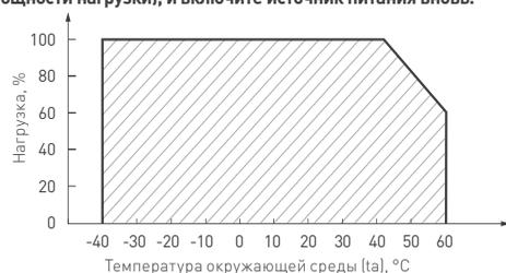
Рис. 3. Максимальная допустимая нагрузка, % от мощности источника
